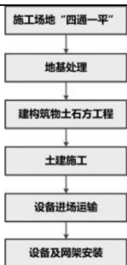
图 3 变电站工程施工工艺流程
