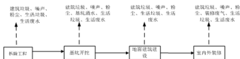
图 3-4 施工期产污环节图
